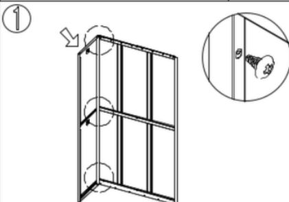
Fije el lado izquierdo al panel trasero con tornillos autorroscantes (5x10).
