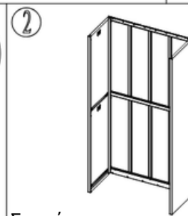
2 Στερεώστε τη δεξιά πλευρά στο πίσω πάνελ με τον ίδιο τρόπο όπως στο πρώτο βήμα.
