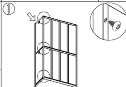
Pieskrūvējiet kreiso pusi un aizmugurējo paneli ar pašvītņojošām skrūvēm (5x10).
