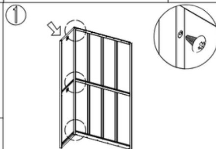
Kiinnitä vasen puoli ja takalevy itsekierteittävillä ruuveilla (5x10).
