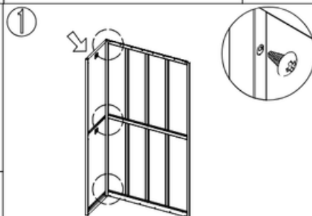
Fixez le côté gauche et le panneau arrière à l'aide de vis autotaraudeuses (5x10).
