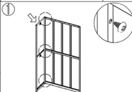
1 Skruva fast vänster sida och bakpanelen med självgående skruvar (5x10).
