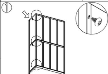
Aparafuse o lado esquerdo ao painel traseiro com parafusos autorroscantes (5x10).
