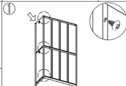
1 Přišroubujte levou stranu a zadní desku samořeznými šrouby (5x10).
