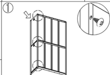
Прикрутите левую сторону и заднюю панель самонарезающими винтами (5x10).
