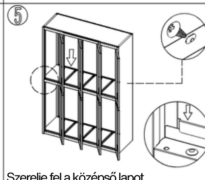
5. Szerelje fel a középső lapot.
