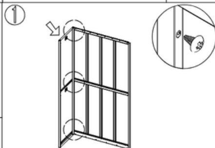
Skrú venstre side og bagpladen sammen med selvskærende skruer (5x10).
