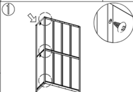
1 Atomille el lado izquierdo y el panel trasero con tornillos autorroscantes (5x10).
