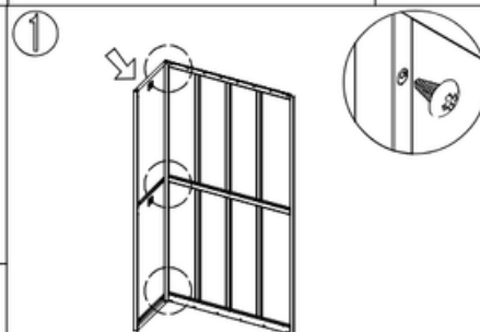
Skrú venstre side og bakplaten sammen med selvborende skruer (5x10).
